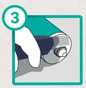
Corte la punta roscada del cartucho perpendicularmente.
